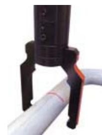
Palpador láser / infrarrojo para mediciones de tubo
